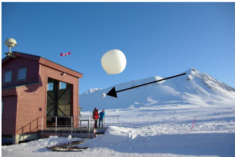
**Abb. 4.7:** Start einer Ozonsonde in Ny-Ålesund. Zur besseren Erkennbarkeit wird auf die Sonde, eine elektronisch chemische Zelle, mittels eines Pfeils hingewiesen. Foto: Jürgen Gräser, ([https://www.awi.de/fileadmin/user\\_upload/AWI/Expedition/Observatorien/Bild/AWIPEV/20130417\\_Ozonsondenstart\\_JGraeser.jpg](https://www.awi.de/fileadmin/user_upload/AWI/Expedition/Observatorien/Bild/AWIPEV/20130417_Ozonsondenstart_JGraeser.jpg)), abgerufen am: 29.11.2016
