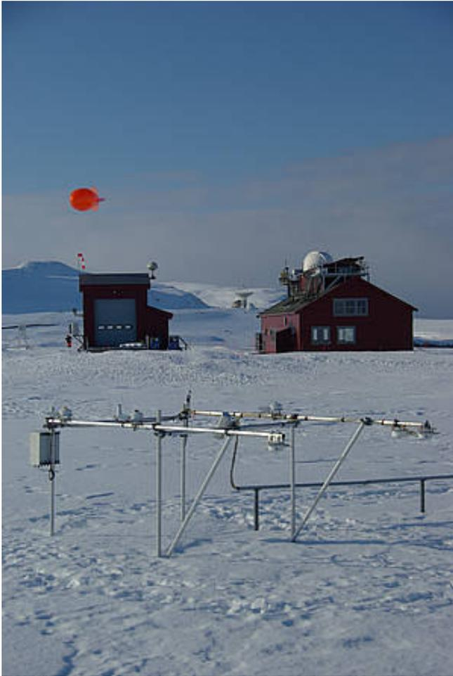
**Abb. 4.9:** Konstruktion zur Messung von Strahlungsarten wie UV-Strahlung, sichtbarer und langwelliger Strahlung. Fotograf: Jürgen Gräser, ([https://www.awi.de/fileadmin/\\_processed\\_/csm\\_NYA\\_Radiation\\_JGraeser\\_2013\\_97eb6dbc1e.jpg](https://www.awi.de/fileadmin/_processed_/csm_NYA_Radiation_JGraeser_2013_97eb6dbc1e.jpg)), abgerufen am: 29.11.2016
