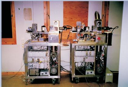
Abbildung 1. Foto des RAM. Auf der linken Seite befindet sich die Optik für das Ozon-Radiometer, auf der rechten für ClO. Die Strahlung fällt durch das Styroporfenster hinter dem Instrument ein. Auf dem Rack befinden sich die Quasi-Optik, die Eichlasten und der Mischer (Gehäuse rechts). Im Rack ist die Verstärkerkette, das Spektrometer (links unten) und die Kontrollelektronik zu sehen.
