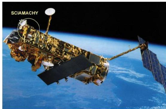
Abbildung 3.1: Der Umweltsatellit Envisat mit dem Spektrometer SCIAMACHY (Gottwald & Bovensmann, 2011)
